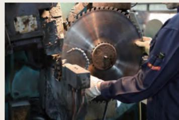
会社情報: 工場内で使う鋸の研磨やメンテナンス、電気や機械全般の管理・保全などを行っています。製材の要となる鋸の刃には注意を払い、時間をかけて作業を行い、常にストレスのない作業へとつなげています。使う人のことを考え、生産性を高めるために日々現場を支える仕事です。最近では従業員への福利厚生を充実させ、働きやすい環境づくりを積極的に行っています。
