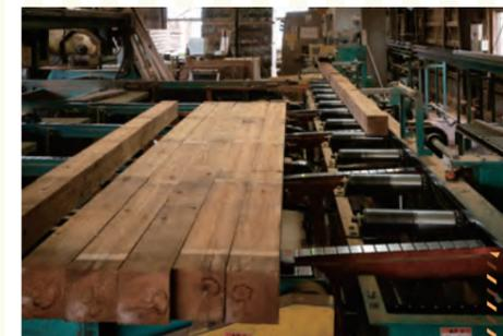
乾燥材には、人工的に温湿度や風量などを制御した施設(釜)を使って製材品を乾燥させたKD材(Kiln Dried Lumber)と、野外で自然に乾燥させたAD材(Air Dried Lumber)があります。一方、グリーン材(Green Wood Lumber)は乾燥処理されていない未乾燥の製材品で、それぞれ状況に応じて利用されています。
