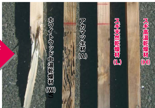
シロアリ食害判定時の杭の様子(食害度評価例: W=5, A=4, L=0, H=1) ※試験: 宮崎県木材利用技術センター
