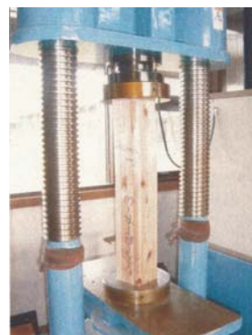
圧縮試験の様子
