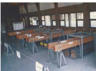
曲げクリープ試験の様子
