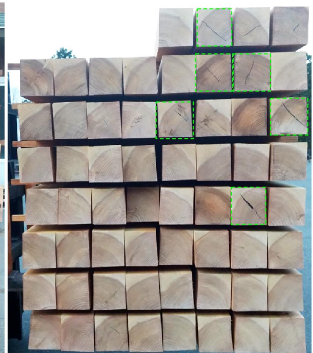
木口割れが発生した試験体
