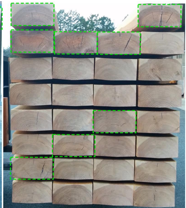
木口割れが発生した試験体
